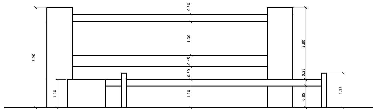
VISTA 01 - CORETO EXISTENTE (REFORMAR) ESC. 1/50
